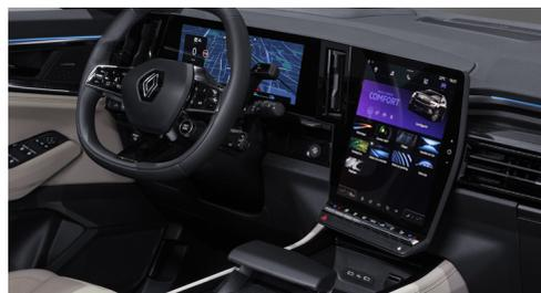
**DAS openR COCKPIT** in Form eines liegenden „L“ vereint das querformatige digitale Kombiinstrument und den hochformatigen Multimediamonitor zu einer Display-Fläche von bis zu 774 Quadratzentimetern.
