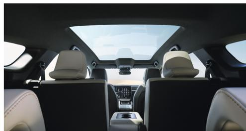
**DAS OPTIONALE PANORAMA-GLASDACH** ist mit 1,33 x 0,84 Meter Fläche eines der größten Glasdächer auf dem Markt. Das Glas ist auf der Innenseite beschichtet, um UV- und Infrarotstrahlen zu filtern sowie Wärme zu reflektieren.
